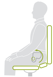
Sitzkeil-Effekt | Die sanfte Unterstützung im Beckenbereich unter- stützt die entspannte, aufrechte Sitzhaltung.
