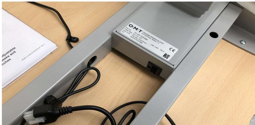
Nun kommt nur noch das Aufstellen des Tisches an den Strom anschließen, eventuell einen Reset mit dem Halten der Pfeil nach unten Taste und Ihr Tisch ist in ca. 15 Minuten fertig aufgestellt.
