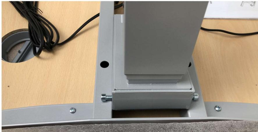
4x Schrauben reindreihen und anziehen + 4 Schrauben anziehen + Stecker verbinden 6Min.
