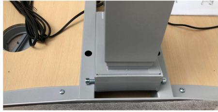
4x Schrauben reindrehen und anziehen + 4 Schrauben anziehen + Stecker verbinden 6Min.
